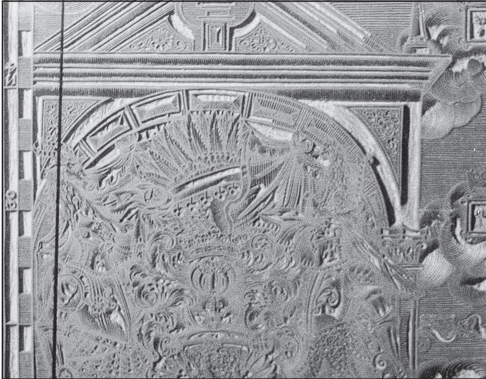
Abb. 5: Druckstock der Karte "Die fr. Grafschaft Tirol" von 1611 mit vertikalem Riss (von links oben beleuchtet)
